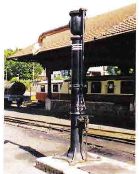
Een waterkraan naar Frans smalspoorvoorbeeld. Deze staat in Lamastre (Ardeche).
